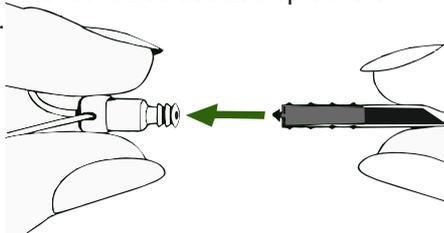
Ziehen Sie den gebrauchten Cerumenfilter aus dem Lautsprecher gerade heraus. Ohne zu drehen!!!
