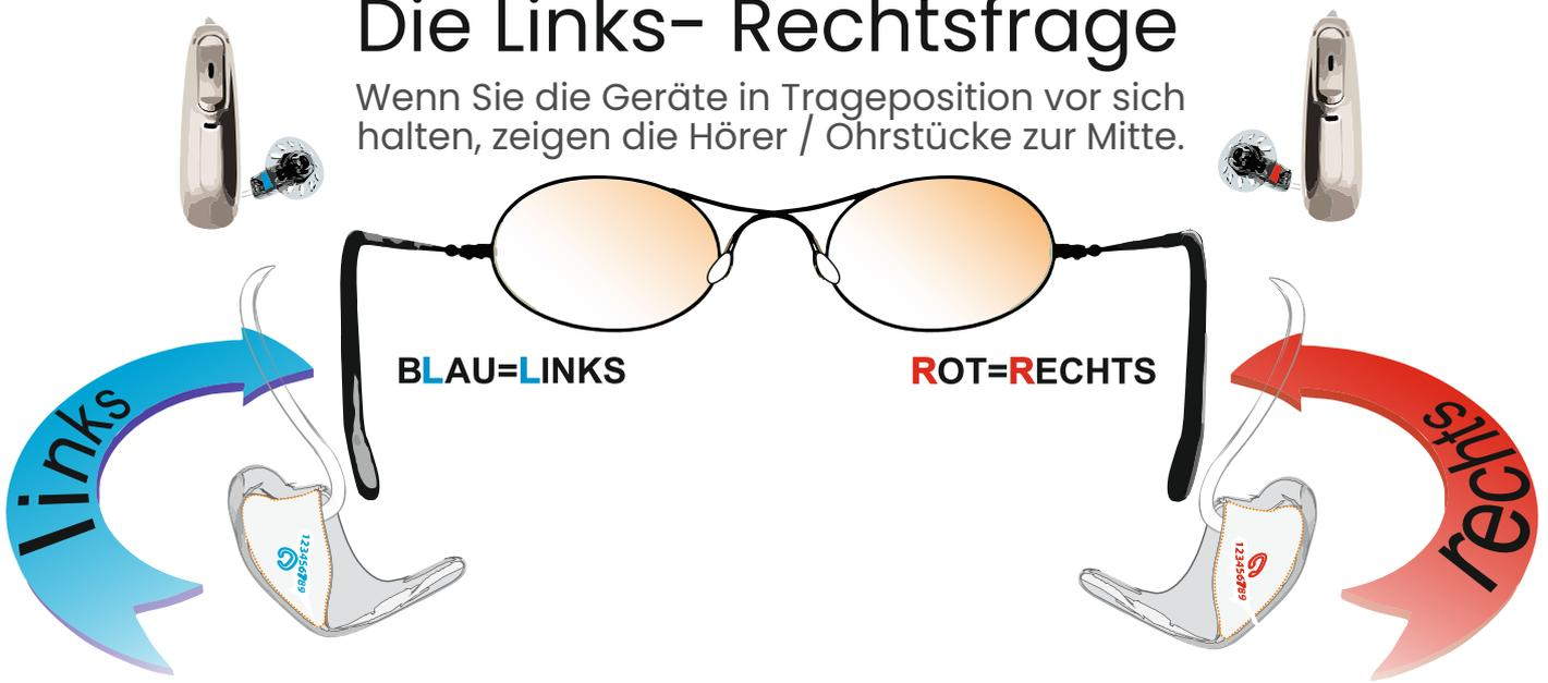
Die Farbmarkierung für **Rechts/Rot** und **Blau/Links** finden Sie auf den Ohrstücken, Hörern oder unterm Schirmchen. Zusätzlich ist dieser Farbcode auch oft im Batteriefach oder an der Unterseite des Gerätes zu finden.
