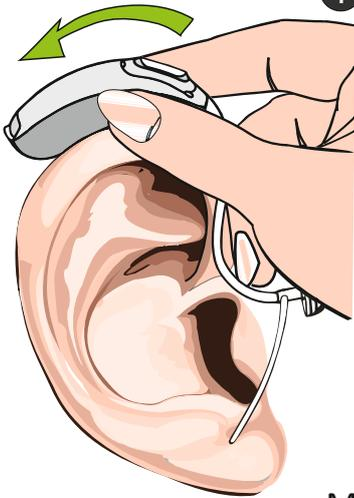
Als erstes klemmen Sie das Gerät wie einen Brillenbügel aufs / hinteres Ohr, so dass das Schläuchlein vor dem Ohr senkrecht nach unten läuft. (so hält es erstmal)
